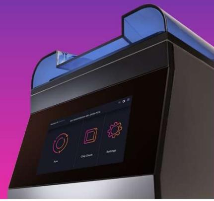
Platinumは、アミノ酸のシーケンスを目的としたエンド・ツー・エンドのベンチトップ型次世代プロテインシーケンサーです。半導体チップ上で検出されたペプチド断片をリファレンス配列にあてることタンパク質を推定します。2022年、ScienceにPlatinumの基盤技術が発表<sup>1</sup>されてから2023年に製品化された最新のタンパク質解析装置です。
